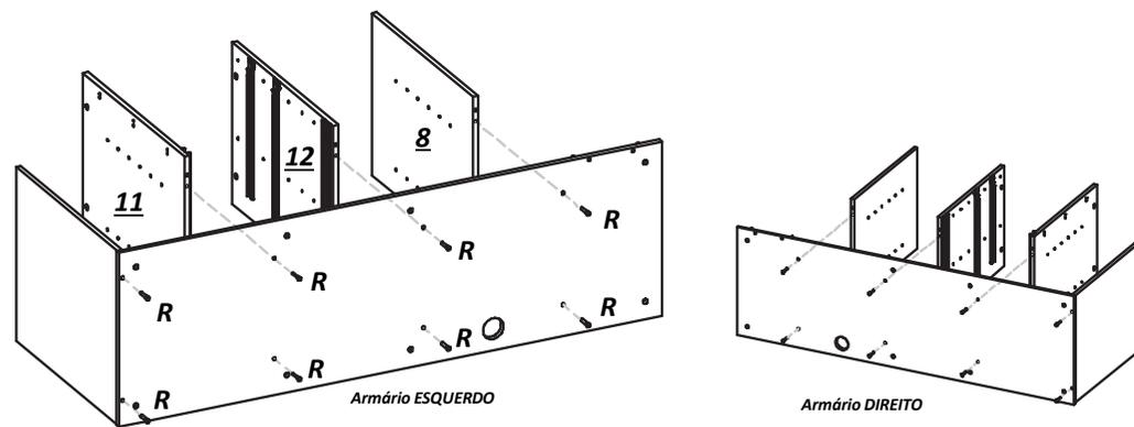
**2.3** Encaixe as laterais e fixe com os parafusos indicados com auxílio da chave allen nº4
