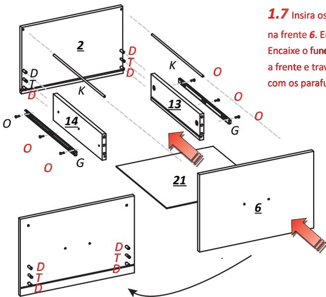
**1.7** Insira os pinos **T** e cavilhas **D** no fundo **2** e na frente **6**. Encaixe as laterais **13, 14** e trave as cuíças **L**. Encaixe o fundo **3mm 21** no canal das laterais, posicione a frente e trave as cuíças. Por fim, fixe as correias **G** com os parafusos indicados na imagem.
