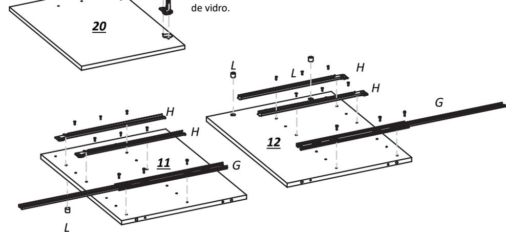
**1.5** Fixe os trilhos **H** com o parafuso 3.5x12N nas laterais internas. Fixe os trilhos **G** com os parafusos 4.0x14 **O** e depois, acople as cuícas.
