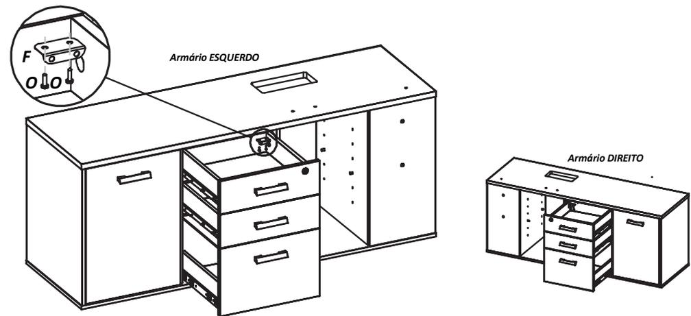
**2.8** Encaixe as gavetas, fixe a chapa trava *F* e fixe com os parafusos *O*.
